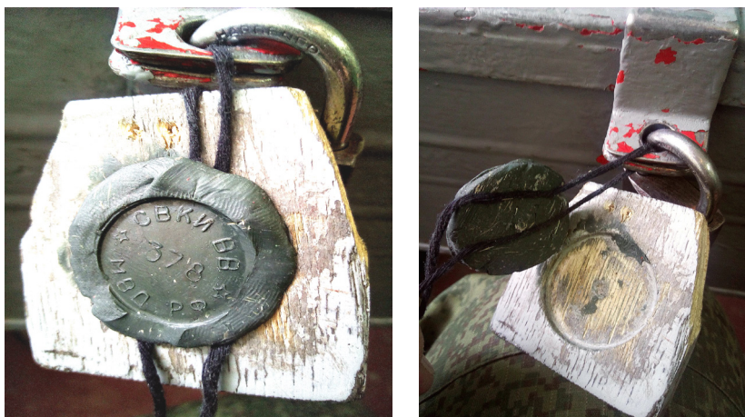
Рисунок 5 – Самопроизвольное отделение слепочной массы от самодельной деревянной навесной плашки: а – состояние опечатывающего устройства до воздействия низкой температуры или высокой влажности; б – отделившаяся слепочная масса. Глубина стакана для слепочной массы недостаточна для его надежного удержания
