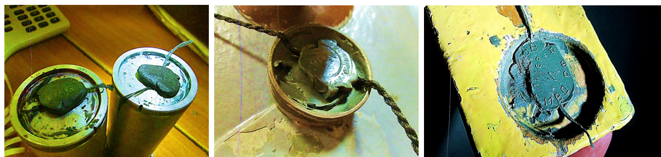
Рисунок 4 – Нарушение правил заполнения углубления (стакана) печатающего устройства слепочной массой
