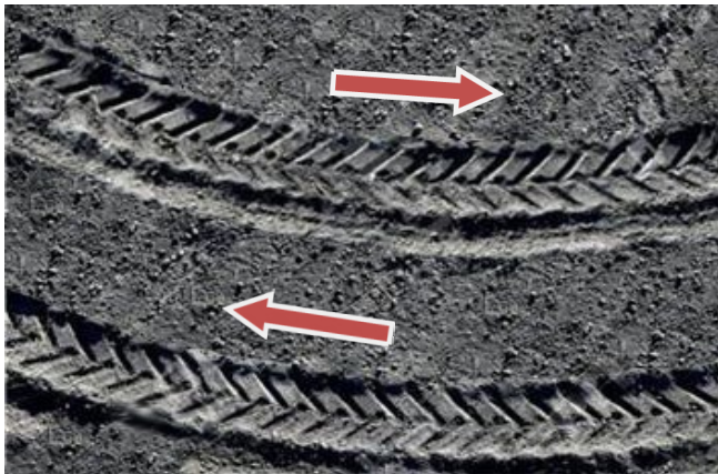
Рисунок 4 – След беговой дорожки, оставленный шинами с направленным рисунком протектора
