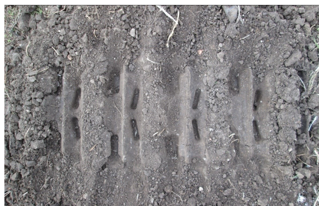
Рисунок 5 – След гусеницы БМП-1(2) на рыхлом грунте с отобразившимися элементами грунтозацепа. Стрелкой указано направление движения БМП (выступающие элементы грунтозацепа образуют угол схождения, вершина которого в следе обращена по направлению, противоположному движению техники)
