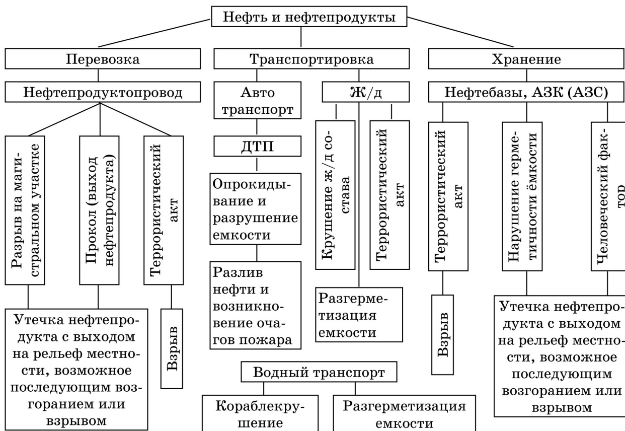
Рисунок 1 – схема ситуационной модели наиболее опасных чрезвычайных ситуаций, связанных с выбросом нефтепродуктов
