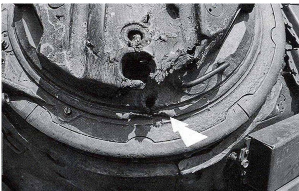
Рисунок 1 – Попадание гранаты РПГ в командирскую башенку Т-72Б1 пробило броню и поразило командира танка. Грозный. Январь 1995 г.
