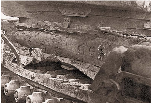
Рисунок 4 – Наличие ящиков ЗИП спасло Т-72Б1 от попадания кумулятивной струи в моторное отделение и соответствующих последствий
