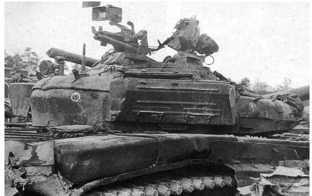
Рисунок 2 – Отсутствие защиты кормы башни в виде ящика ЗИП привело к пробитию брони и гибели командира танка в бою за Грозный. Январь 1995 г.
