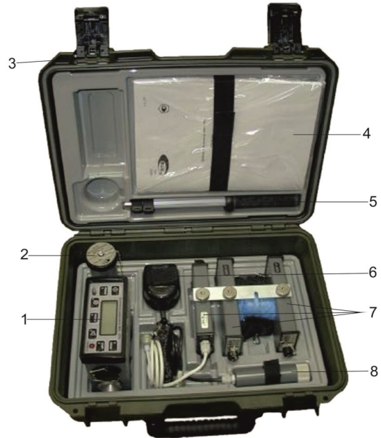
Рисунок 2 – Измеритель мощности дозы ИМД-7Н: 1 – измерительный блок; 2 – (пульт) блок детектирования БДПА-07; 3 – укладочный футляр; 4 – руководство по эксплуатации, формуляр; 5 – штанга телескопическая; 6 – адаптер внешний сетевой; 7 – блок детектирования БДКС-07; 8 – батарейный отсек
