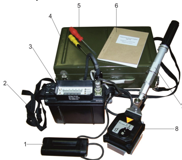
Рисунок 1 – Измеритель мощности дозы ИМД-2НМ: 1 – футляр батарейный; 2 – ремень; 3 – пульт измерительный; 4 – ящик для переноски; 5 – ЗИП; 6 – документация; 7 – штанга удлинительная; 8 – блок детектирования
