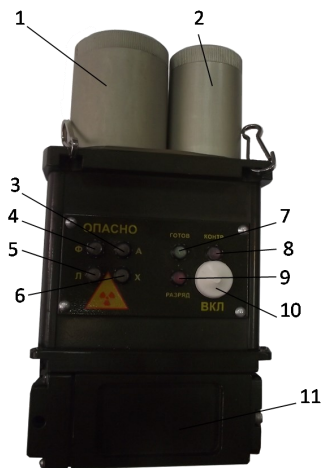
Рисунок 4 – Блок индикации: 1 – преобразователь концентрации ионизационный; 2 – преобразователь концентрации; 3, 4, 5, 6 – светодиоды «Опасно» (А – о наличии паров аммиака, Х – о наличии паров хлора, Ф и Л – о наличии отравляющих веществ); 7 – светодиод «Готов» сигнализации готовности блока индикации; 8 – светодиод «Контр» сигнализации проверки блока индикации; 9 – светодиод «Разряд» сигнализации о разряде аккумулятора; 10 – кнопка включения-выключения блока индикации; 11 – крышка блока питания
