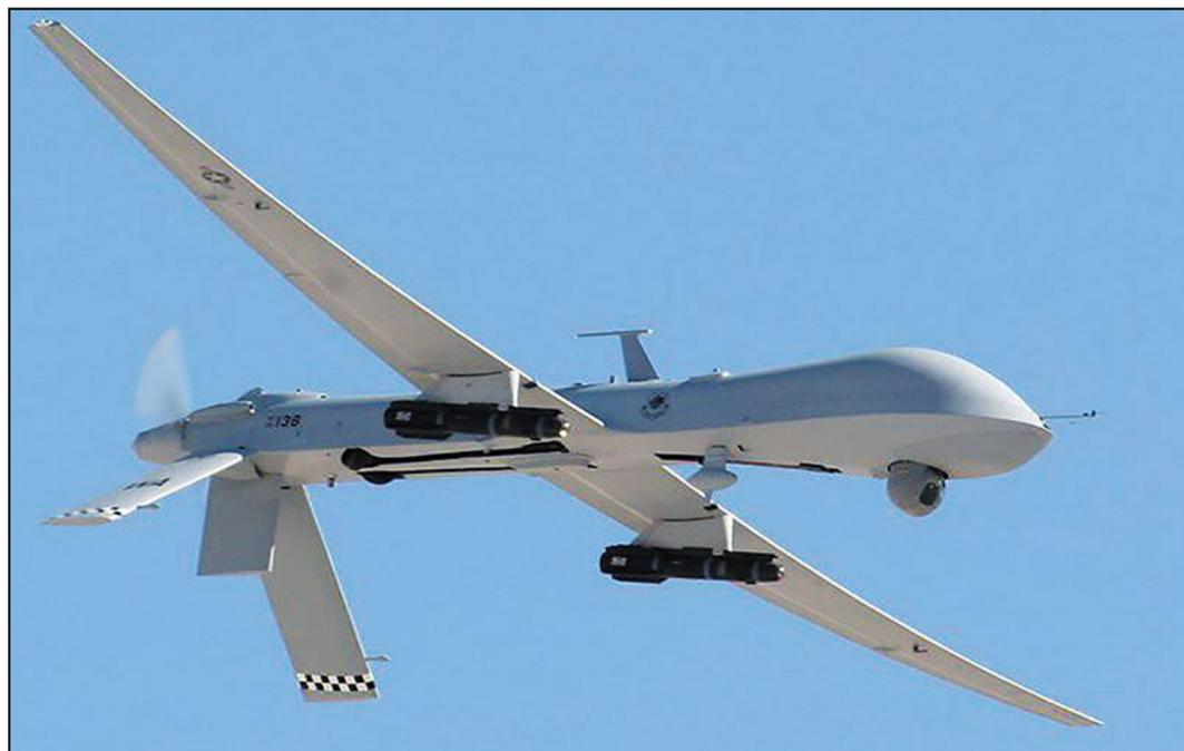
Рисунок 6 – ударный разведывательный БПЛА MQ-1 Predator
